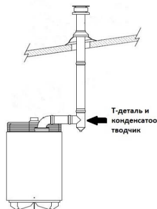
Рисунок 9.1.1 Возможные варианты дымоходов - горизонтальный через стену, вертикальный через крышу
